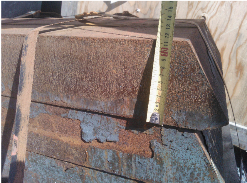
Kuva 10. Aikaisemmin syöttösuppilossa käytettyjä kulutuspaloja. (kuva Kimmo Keltamäki 2013)
