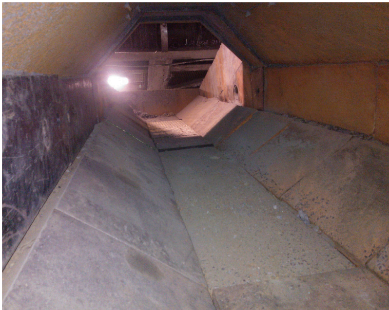
Kuva 6. SAG myllyn syöttösuppilon kulumispaloja. (kuva Kimo Keltamäki 2013)
