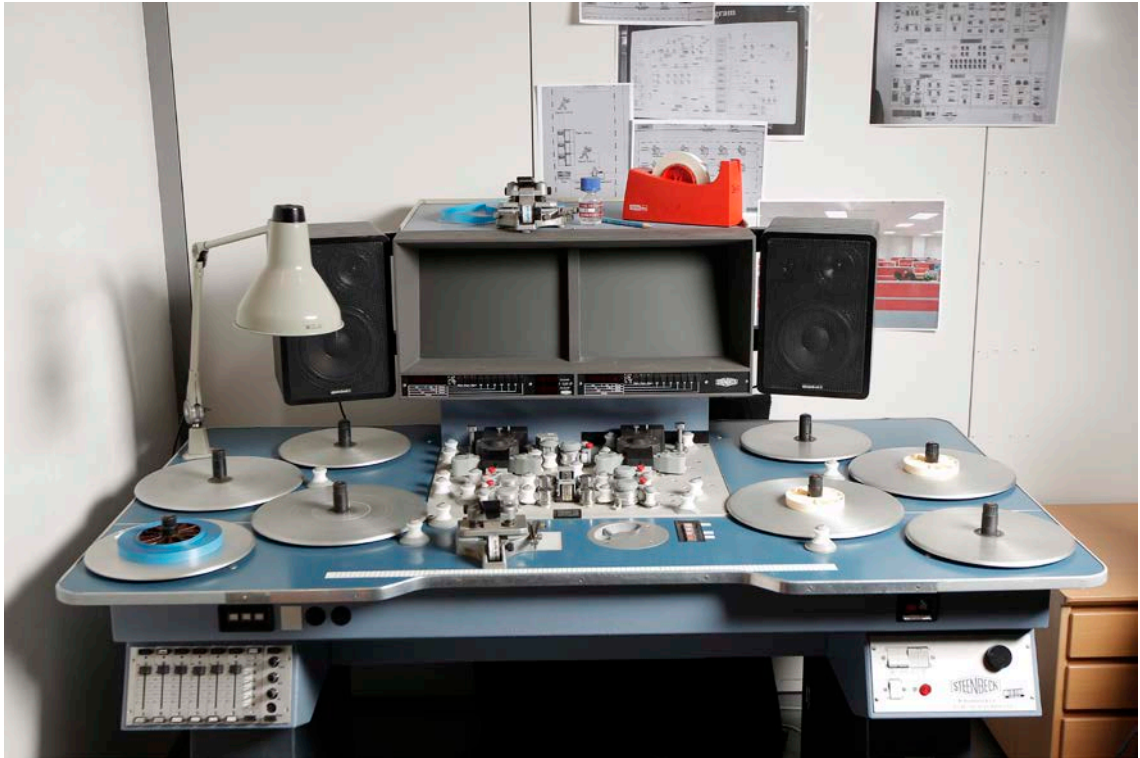
Kuvio 1. Mekaaninen leikkaaminen ja materiaalin katselu tapahtui leikkauspöydällä. Steenbeck ST 921 -leikkauspöytä (DRs Kulturarvsprojekt)
