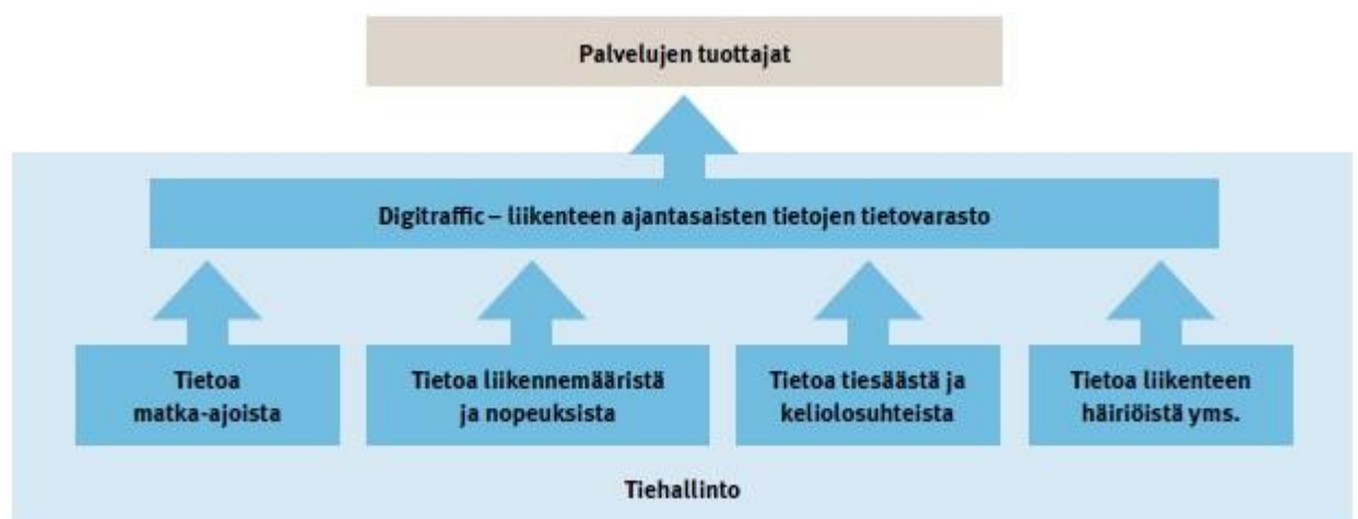
Kuvio 3: Digitrafficin tietojen muodot ja kulku kerääjältä palveluntuottajalle (Digitraffic: Digitraffic – tietopankki tieliikenteen palvelujen kehittäjille. 2008)
