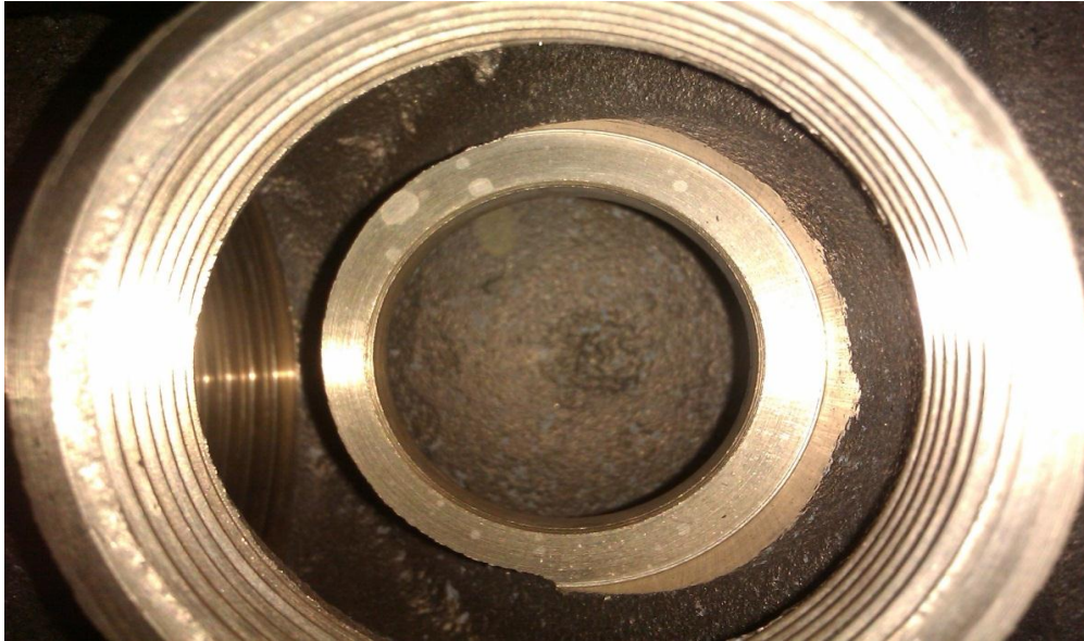
Kuva 29. Venttiilin virtausaukko ja seeti
