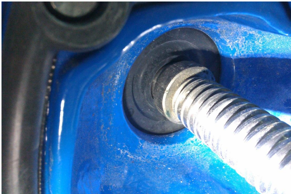
Kuva 12. Karan tiivisteenä on käytetty kumirengasta
