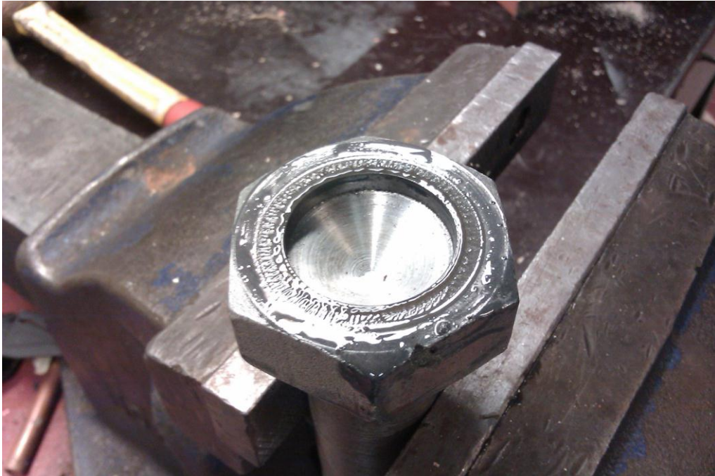
Kuva 16. Seklan hiontaan käytetty pultti
