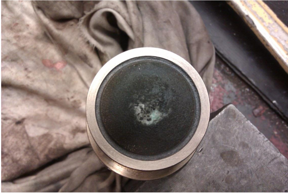
Kuva 18. Kunnostettu sekla. Hiontaan on käytetty yllä olevaa pulttia
