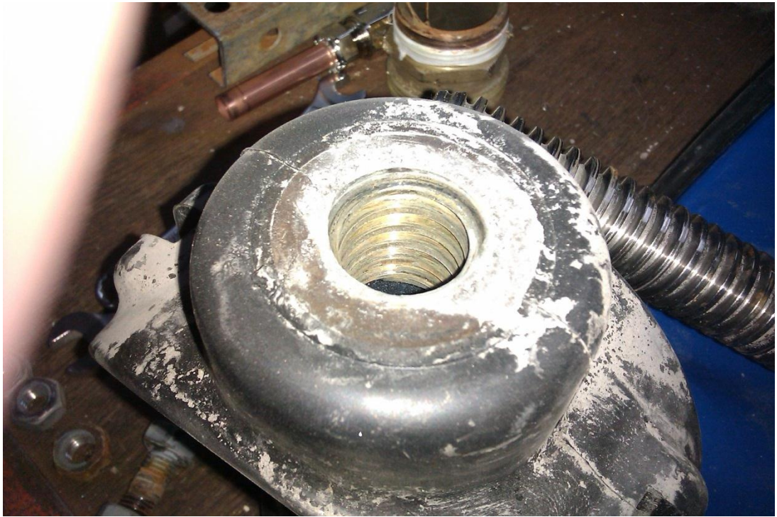
Kuva13. Luisti on kiinnitetty karaan yksinkertaisesti kierteen avulla
