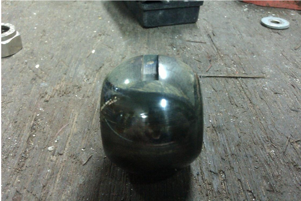
Kuva 24. Palloventtiilin pallo. Pallon päällä oleva ura on kiinni venttiilin karassa olevassa ulokkeessa. Kahvaa käännettäessä karan uloke kääntää palloa venttiilin pesässä
