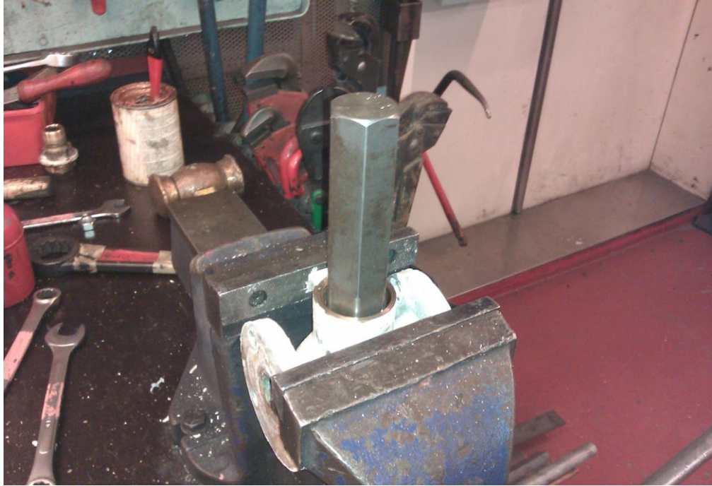
Kuva 19. Metallitangosta valmistettu seetin hiomatyökalu
