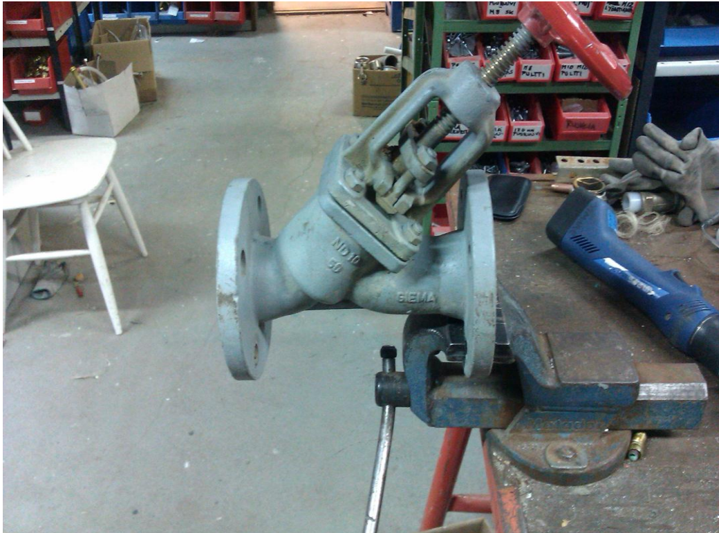
Kuva 2. Istukkaventtiili, jonka tiivistyssuunta on 45 astetta
