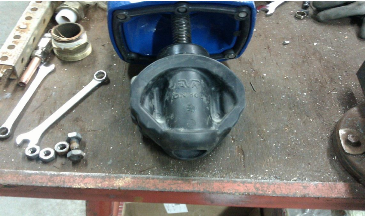
Kuva 11. Kumiluisti. Venttiilin kansi on ruuviliitoksella kiinni venttiilinrungossa. Kannen tiivisteenä on käytetty paksua kumia. Luisti on kuminen ja täysin vaihdettavissa
