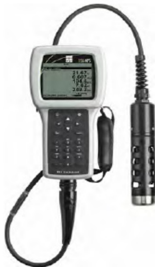
KUVA 4. Low flow -päätte parametrien seuraamiseen (YSI Environmental 2013)
