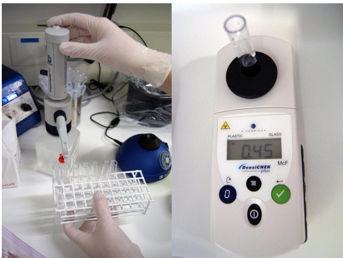
Figur 16. Dispensering av natriumkloridlösning med Dispensette® samt kontroll av McFarland med DensiChek™.
