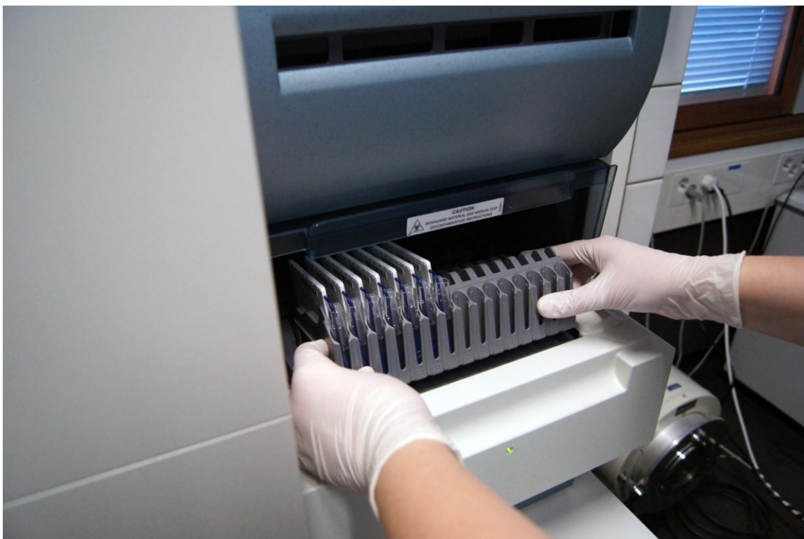
Figur 19. Placering av rack i Vitek® 2 -analysatorn.
