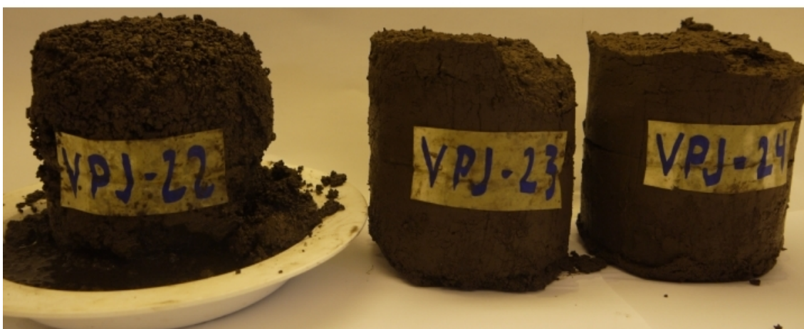
Kuva 10 6% PlusSe koekappaleet jäädytys-sulatuskokeen jälkeen
