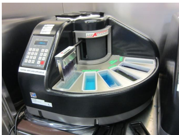
KUVA 20. Islabin hematologian laboratorion värjäysautomaatti.
