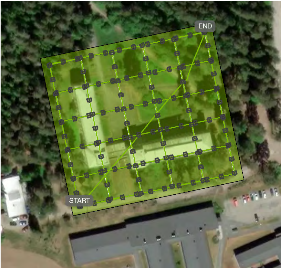
KUVA 3. Lentoreitti Pix4DCapture-ohjelmassa (kuva Juha Vihavainen).
