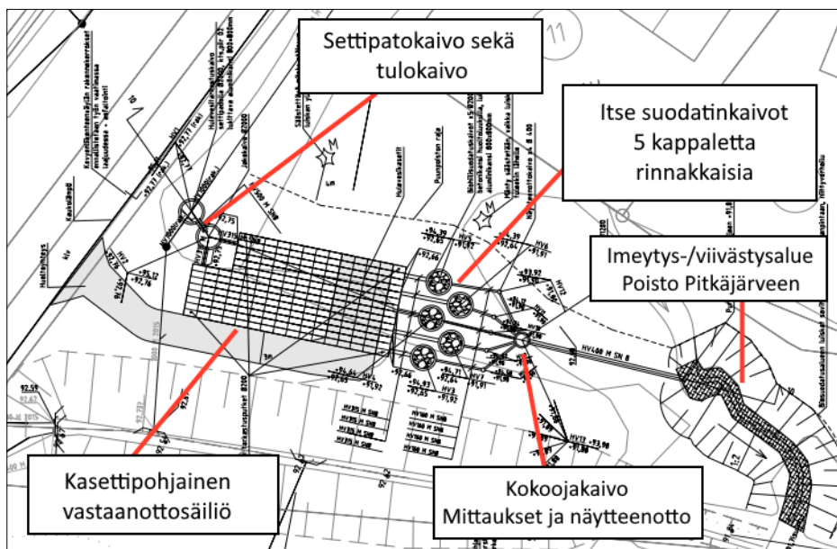
KUVA 2. Pitkäjärven hulevesijärjestelmän asemapiirros (Mikkelin kaupunki, 2019 muokailen).
