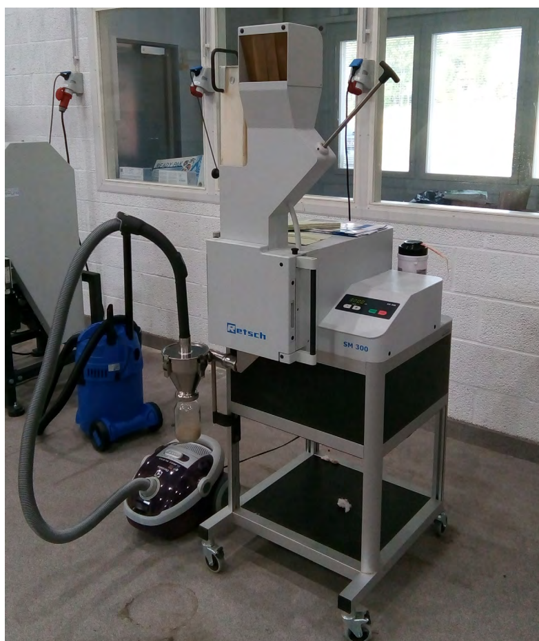
KUVA 3. Leikkuumylly SM300 bio- ja kiertotalouden tutkimuskeskus BioSammossa. (Kuva Eveliina Kuokkanen)
