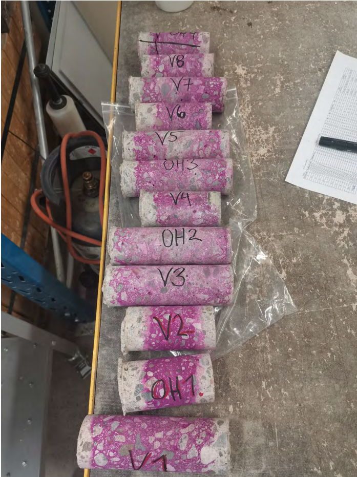
KUVA 1. Rakenteesta irrotettuja betonilieriöitä, joiden pinta on värjätty fenoliftaleiini-liuoksella (kuva Matti Havuaho).
