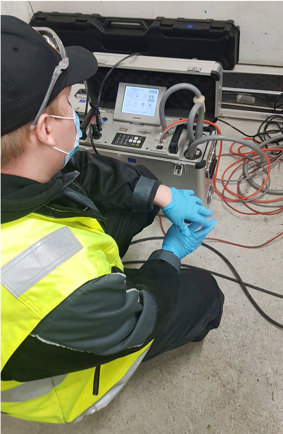
KUVA 2. Kiertovirrat-hankkeessa monitoroitiin jätevesilietteen polton päästöjä (kuva Salla Pulliainen).
