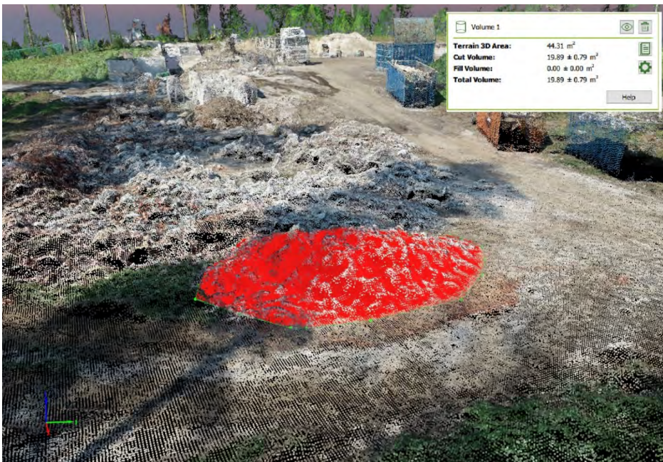
KUVA 5. Tilavuuslaskentaa Pix4DMapper-ohjelmistolla (kuva Juha Vihavainen).
