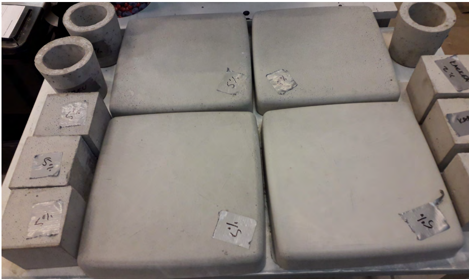
KUVA 1. Hankkeen testeissä korvataan sementtiä biohiilellä betonituotteissa (kuva Riina Tuominen).
