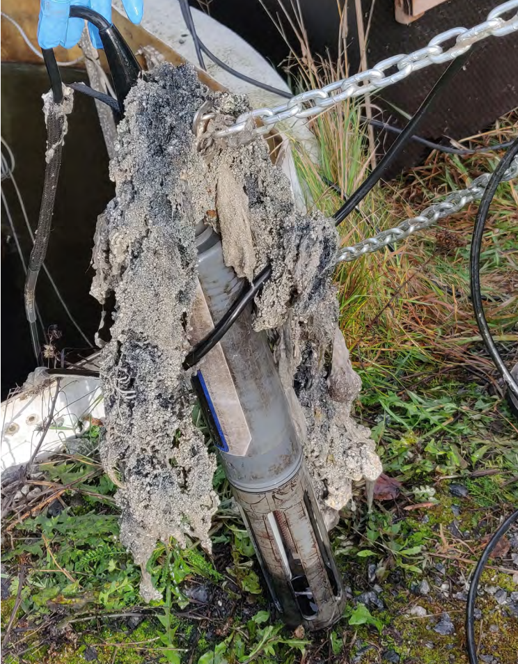
KUVA 5. Jäteveden mukana kulkeutuvaa kiintoainesta kiinnittyy mittalaitteisiin vaikuttaen mittaustuloksiin (kuva Lasse Hämäläinen).
