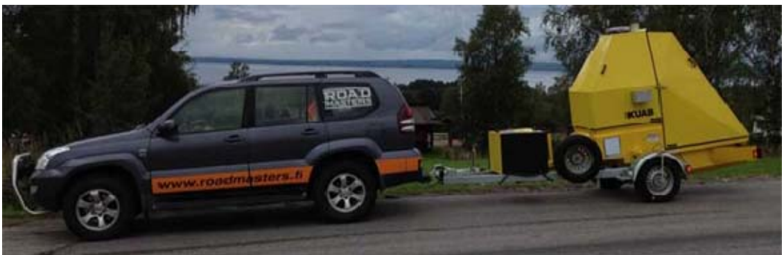
Kuva 19. Pudotuspainolaite KUAB FWD 50 (18.)
