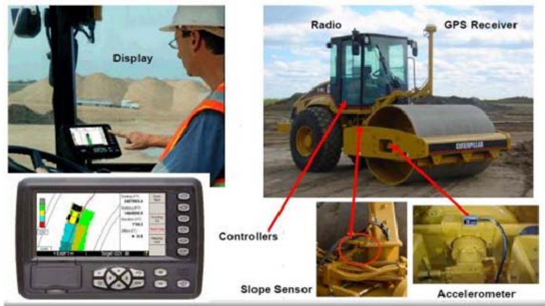
Kuva 14. Täryjyrään asennettu tiivistystyön tarkkailulaite (14.)
