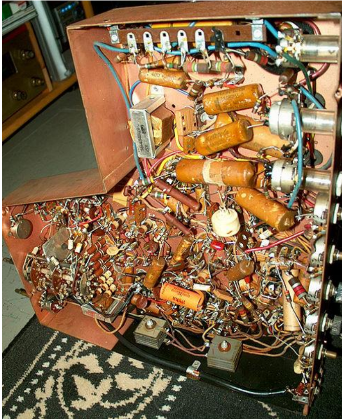
KUVA 1. Point-to-point -menetelmällä rakennettu televisio 1940-luvun lopulta
