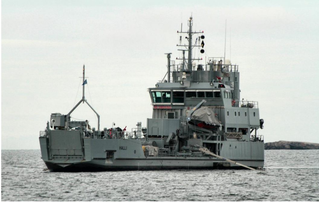
Kuva 7. Öljyntorjunta-alus Halli varustettuna sisäänrakennetulla harjakeräysjärjestelmällä, levikepuomeilla ja öljynkeruusäiliöllä
