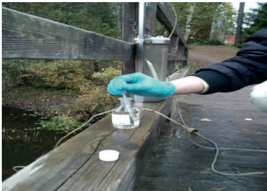
KUVA 5. Anturin mittaustulosta tukeva happinäyte (kuva Piia Aarniosalo)
