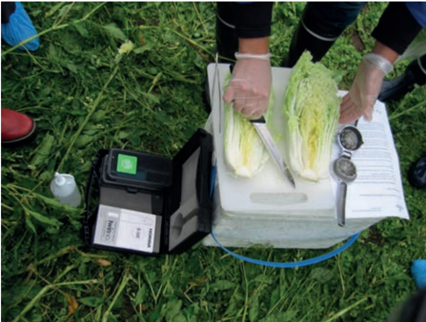
KUVA 4. Kiinankaalinäytteen nitraattipitoisuuden määrittäminen koulutuksen aikana Juvalla (kuva Hanne Soininen)
