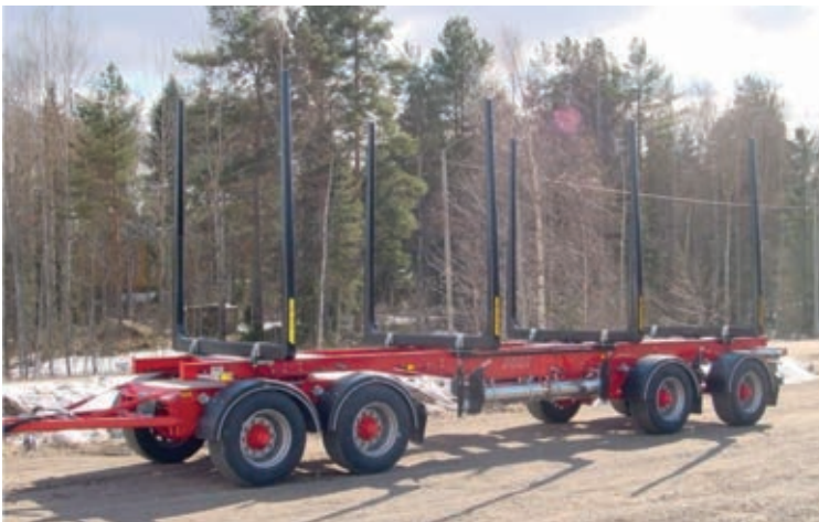
KUVA 3. Kevyt siirto-käyttöön tarkoitettu puutavaraperävaunu (kuva Jyky Oy)
