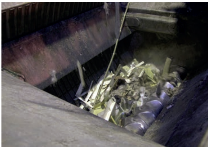
KUVA 5. Lujitemuovijätettä esimurskaimessa (kuva Markus Bruun)
