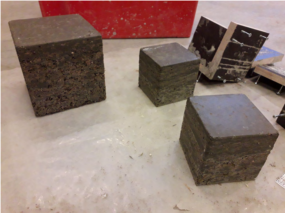
KUVA 2. Puristuslujuusstandardin mukaisia puubetonivaluja (kuva: Hannu Turunen).
