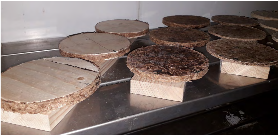
KUVA 11. Koelevyjä tasaantumassa olosuhdehuoneessa (kuva: Hannu Turunen).
