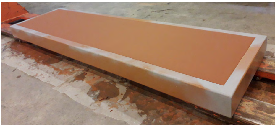
KUVA 7. Itsetasoittuvalla massalla tehty pintavalu (kuva: Hannu Turunen).
