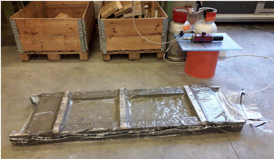
KUVA 4. Ilmanpoisto alipainesäkitystä käyttäen (kuva: Hannu Turunen).
