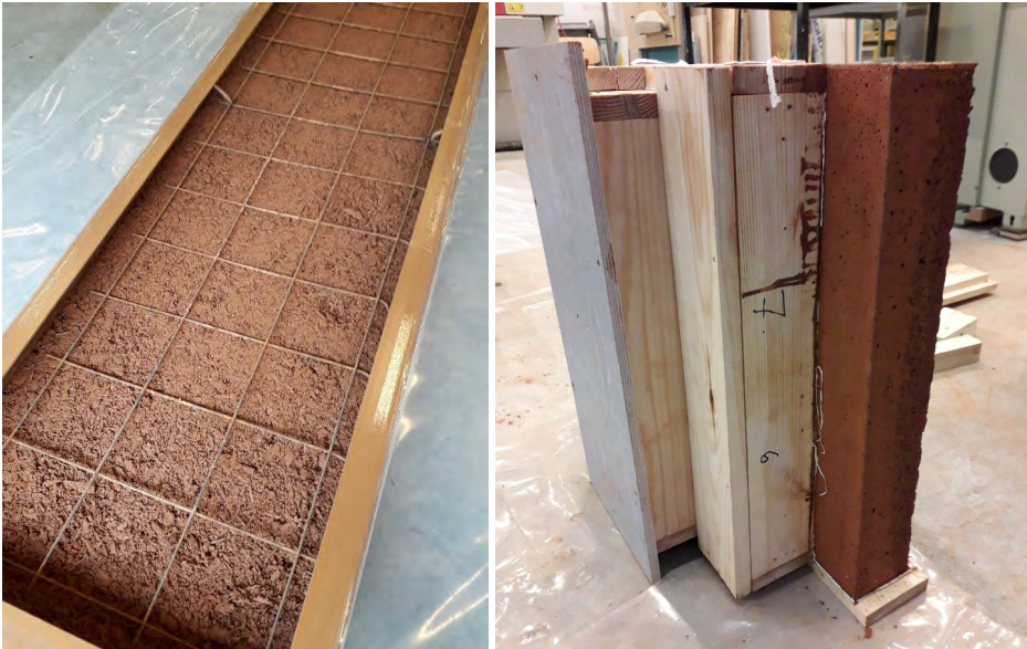
KUVA 6. Vasemmalla puubetonimassaa muotissa ja oikealla jalan muotin avaaminen (kuva: Hannu Turunen).
