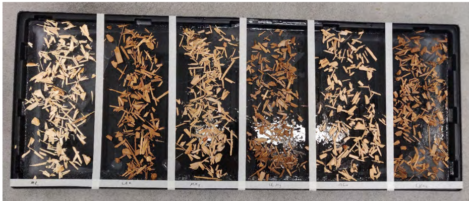
KUVA 7. Suolaliuoksella käsiteltyjen puumurskeiden testaus jääalustalla kontrolliin verrattuna (kuva: Lasse Hämäläinen).
