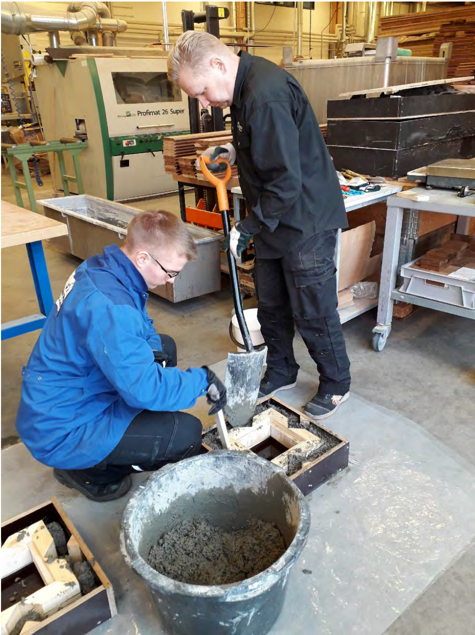
KUVA 3. Puubetonivalujen tekemistä (kuva: Hannu Turunen).
