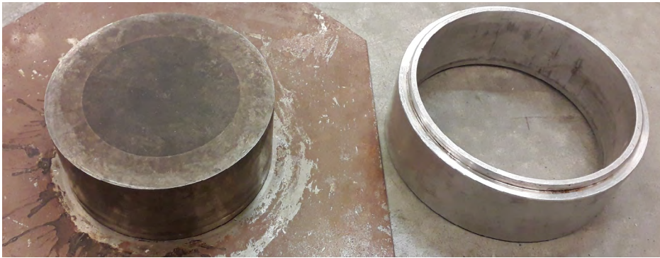
KUVA 10. Muotin teräksinen yläpainin kuvassa vasemmalla ja alaosa kuvassa oikealla (kuva: Hannu Turunen).
