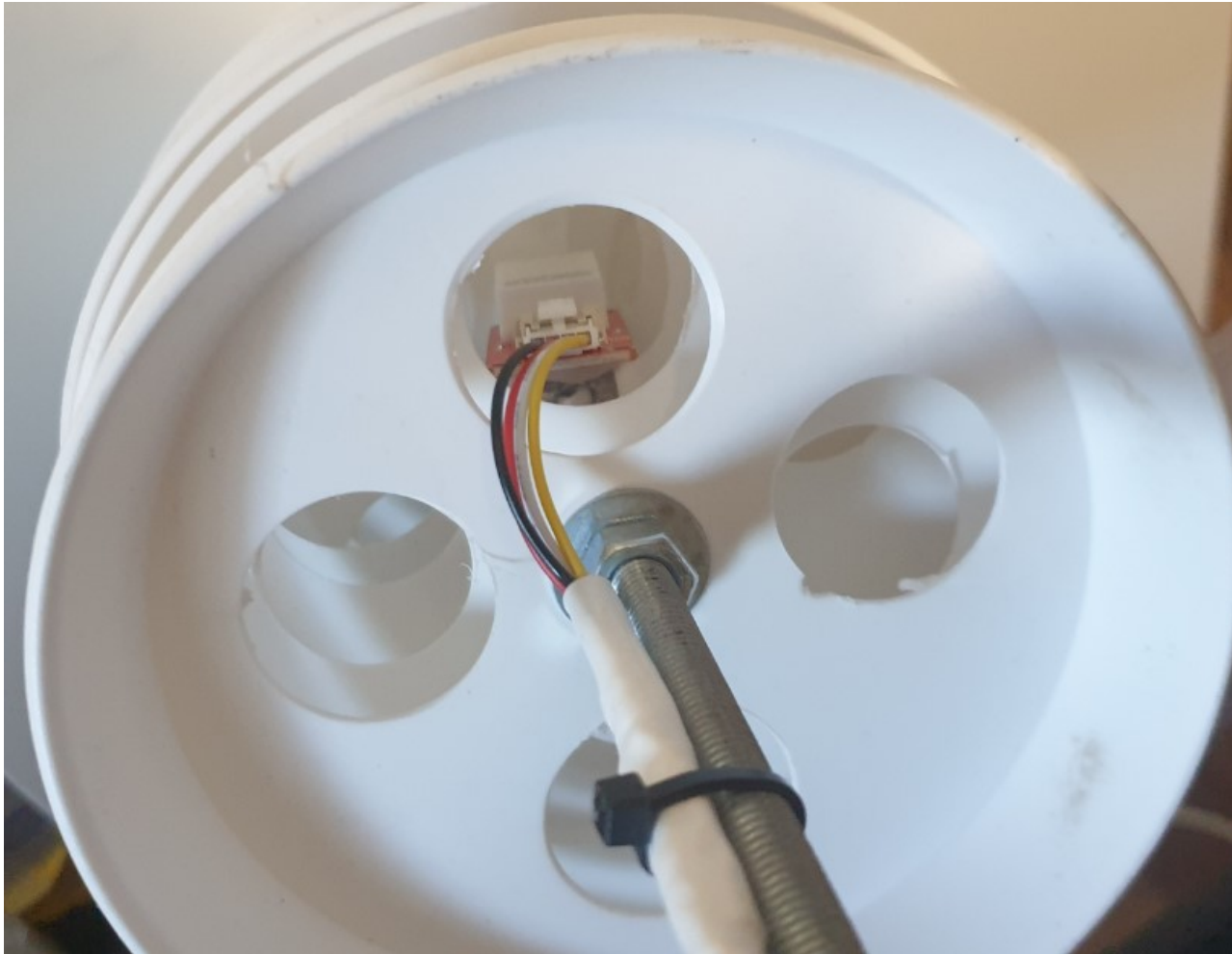
Kuva 14. Lämpötila-anturi paikoillaan kotelossa.
