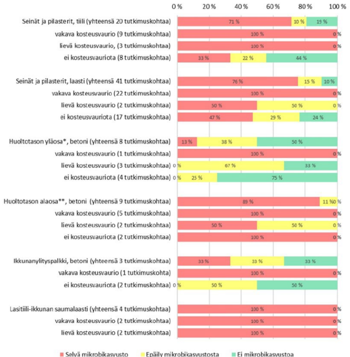
Kuva 15. Mikrobianalyysien tulokset eriteltyinä rakenneosiin. Vahanen rakennusfysiikka Oy.
