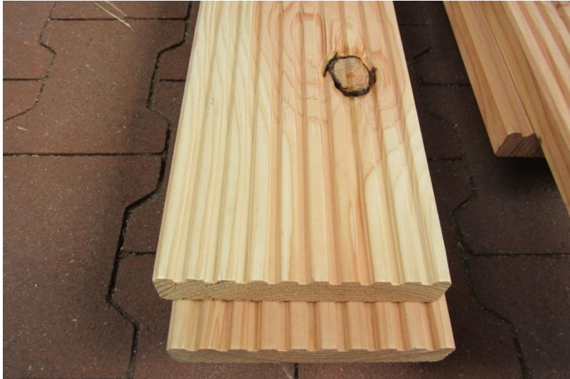
Kuva 2. Kuvassa karkeasti lovettua, douglaskuusesta valmistettua terassilautaa. Myös lehtikuusi oli usein vastaavalla tavalla karkeasti lovettu. (kuva J. Pohjala)
