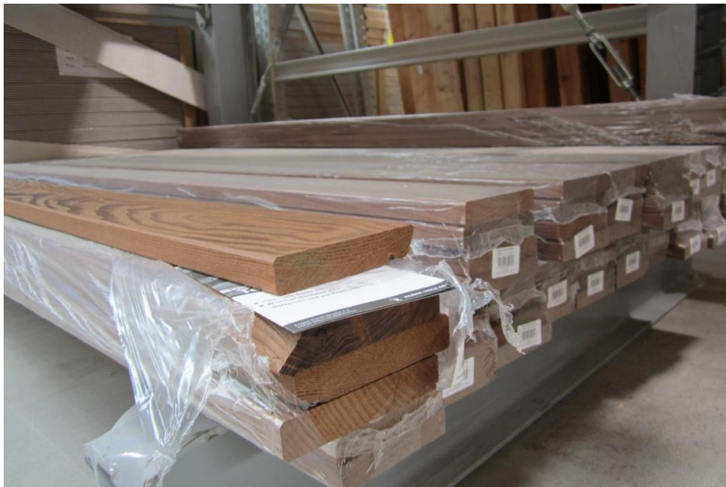
Kuva 5. Molemmilta puolilta tasaista, lämpökäsiteltyä saarnea, oli saatavilla kattavasti. (Kuva J. Pohjala)
