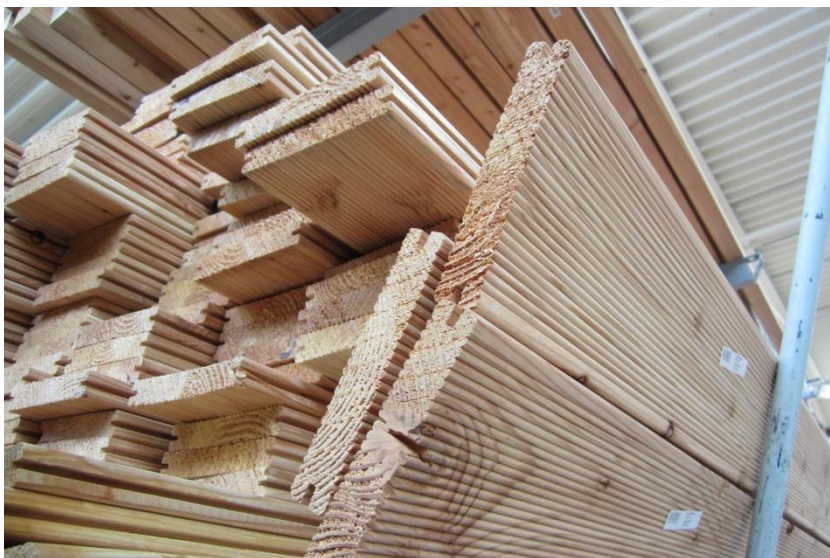
Kuva 3. Euroopan lehtikuusesta valmistettu, molemmilta puolilta rosokuvioinen terassilauta. Tuotteen valmistaja oli Klenk Holz AG (kuva J. Pohjala)
