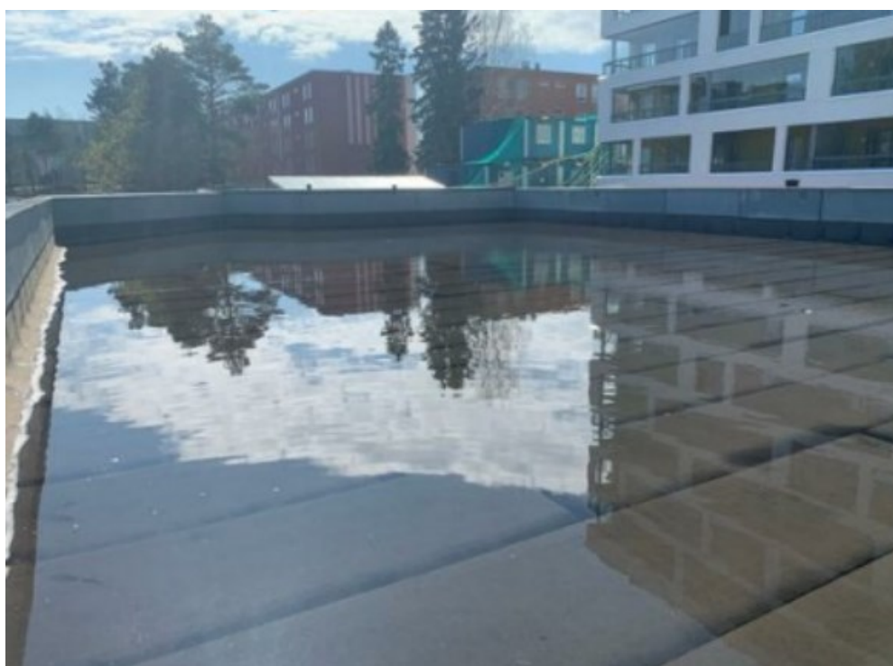
Kuva 11. Autohallin kannen vedenpainekoe (Kuva: Samuli Viitala)
