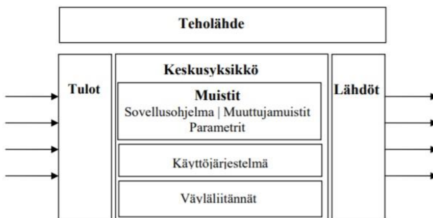
KUVA 17. Ohjelmoitavan logiikan ohjauskokonaisuus (OMRON n.d., 8)
