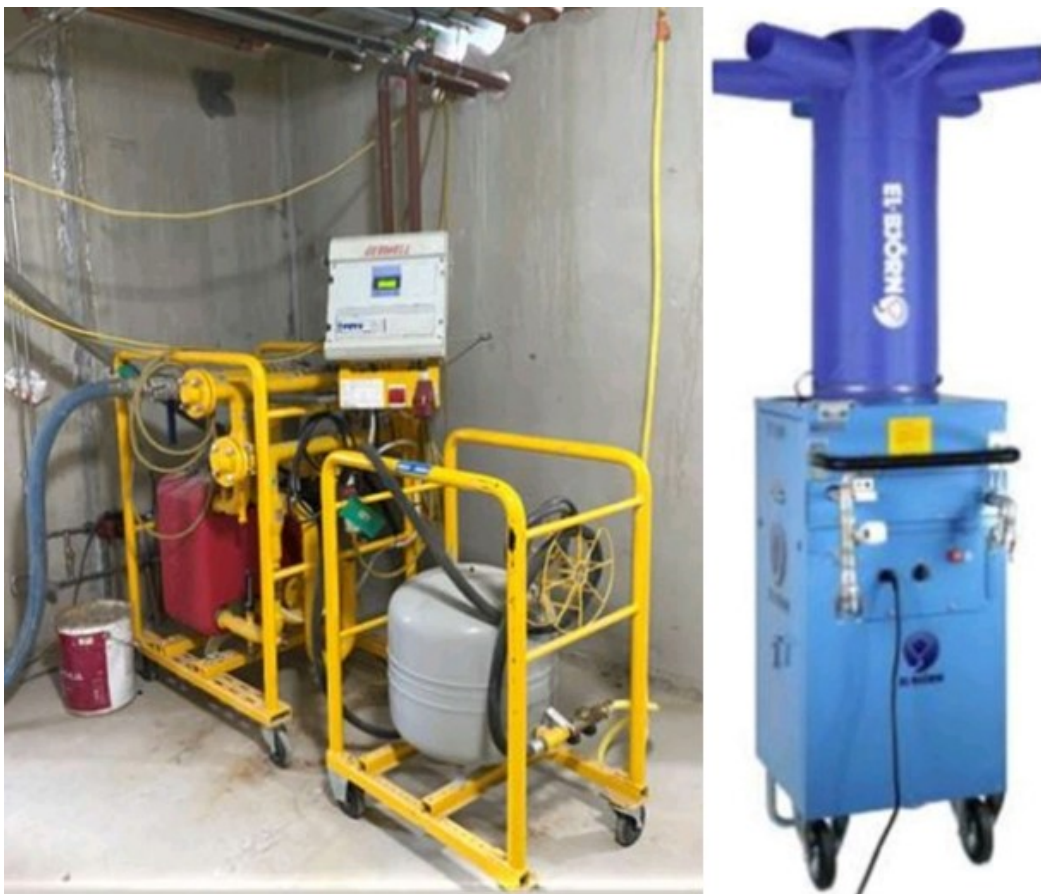
Kuva 11. Työnaikaista lämmityskalustoa. Kuva: YIT.
