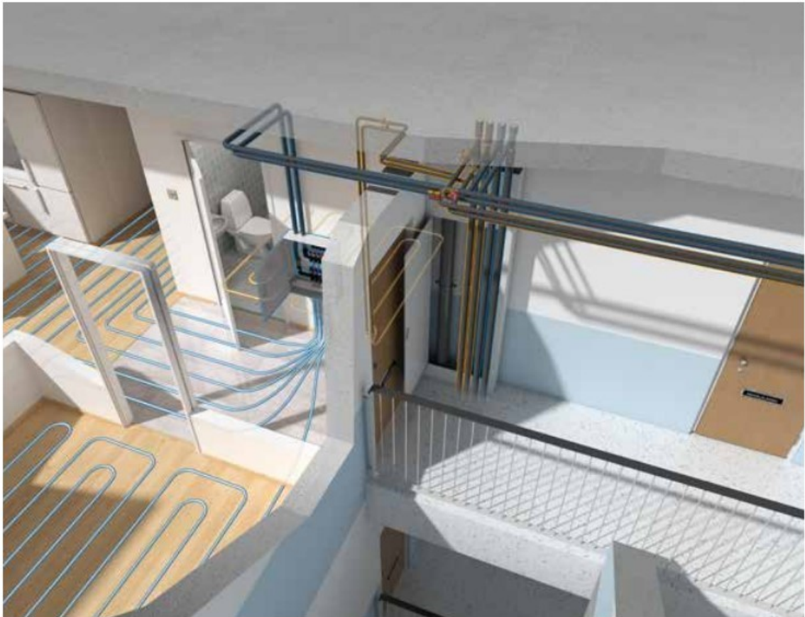
Kuva 1. Runkolinjojen keskitys porrashuoneeseen. [4, s. 11.]
