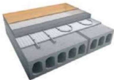
Kuva 3. Välipohjaholvien tacker-tyyppinen lattialämmitysrakenne. [4, s. 23.]
