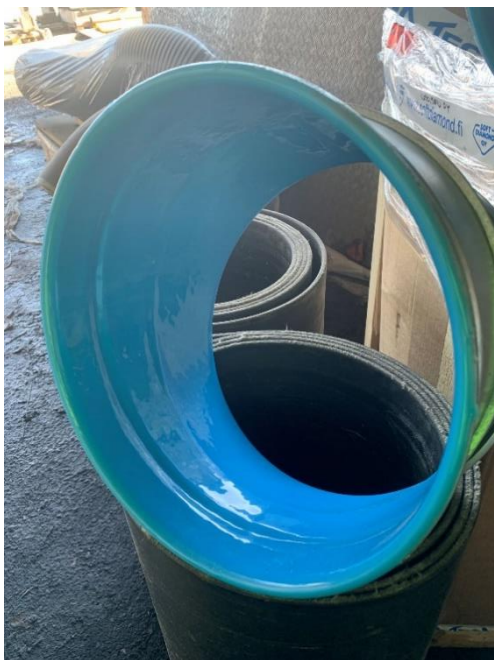
Kuva 7. Polyuretaanielastomeeri eristetty hakeputki.
