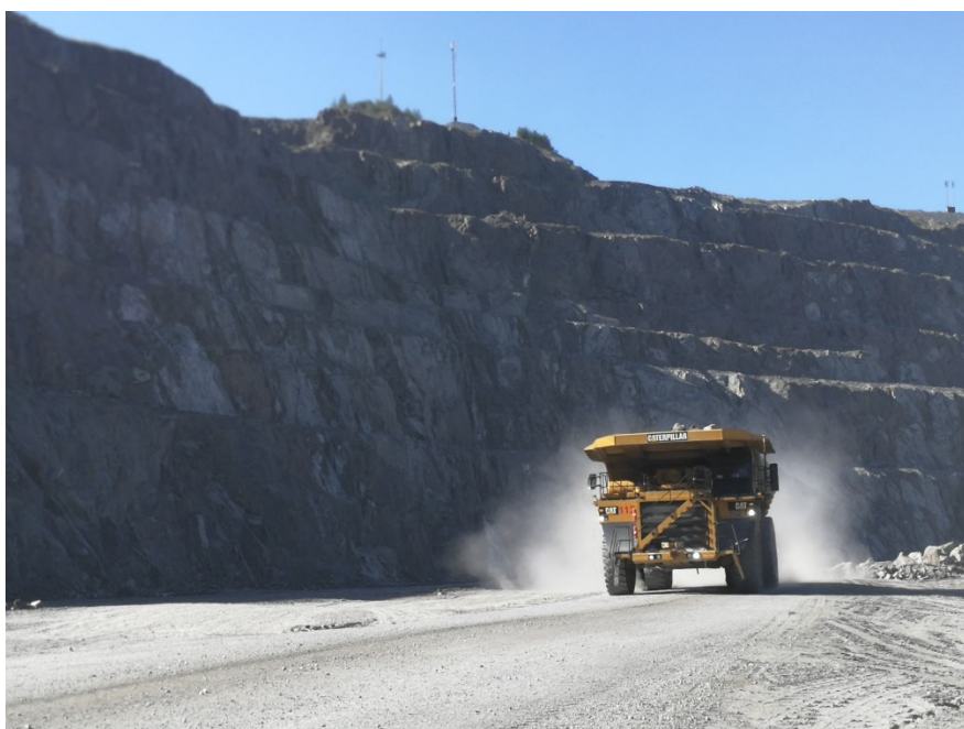
KUVA 9. Kuiva tienpinta pölysee kiviauton alla paljon ja vaatii kastelua. (RÖNKÄ 2018-07-23)
