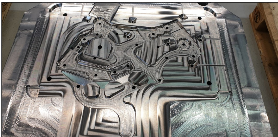
KUVA 6. Kaksiosaisen muotin liikkuva puoli (Muottivalmistaja, 2021)
