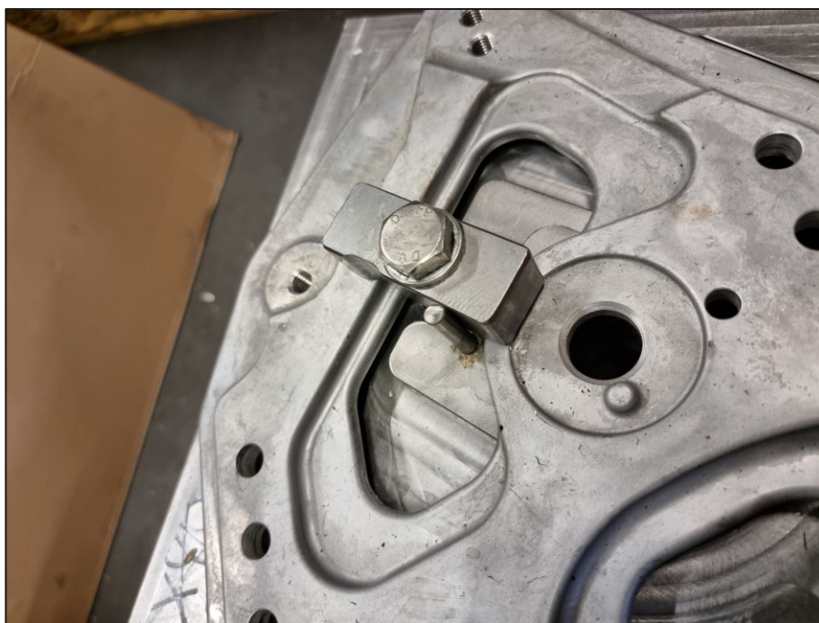
KUVA 8. Z-suunnan jousikuormitteinen pidike toleroidun piirteen lähellä.
