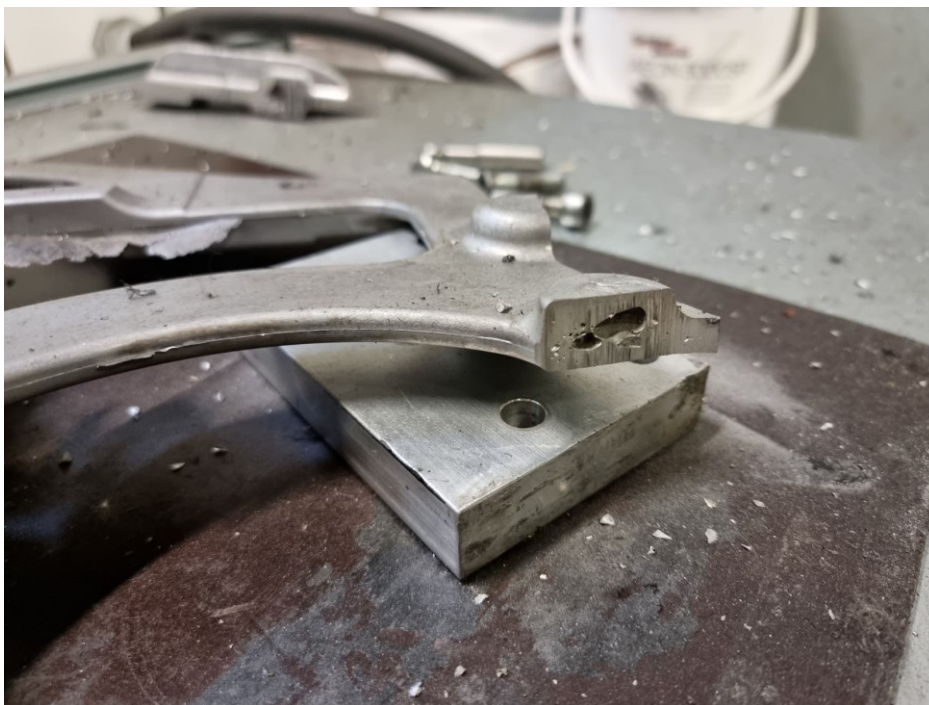
KUVA 17. Testivaluista löytynyt huokonen
