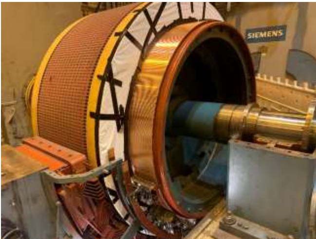
Valssituolin F4-päämoottorin roottori, jonka kommutaattori on sorvattu
