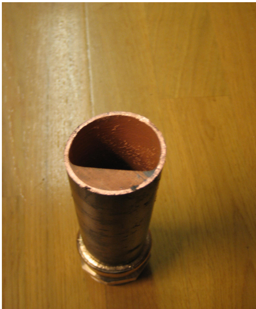
Kuva 3. Vesijohdon pinnoitteen valuma 50 mm:n kuparisessa vesijohtoputkessa (MAH Isännöinti Oy)
