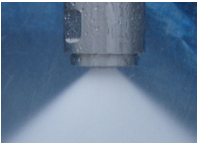
KUVA 6. Prosessivesisuutin ja suihkutuskuvio (Prem 2015, 30.)
