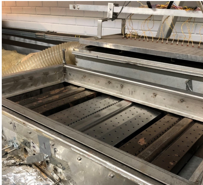
Kuva 16. Alfasimulaattori, jossa mitattava suutin keskellä.
