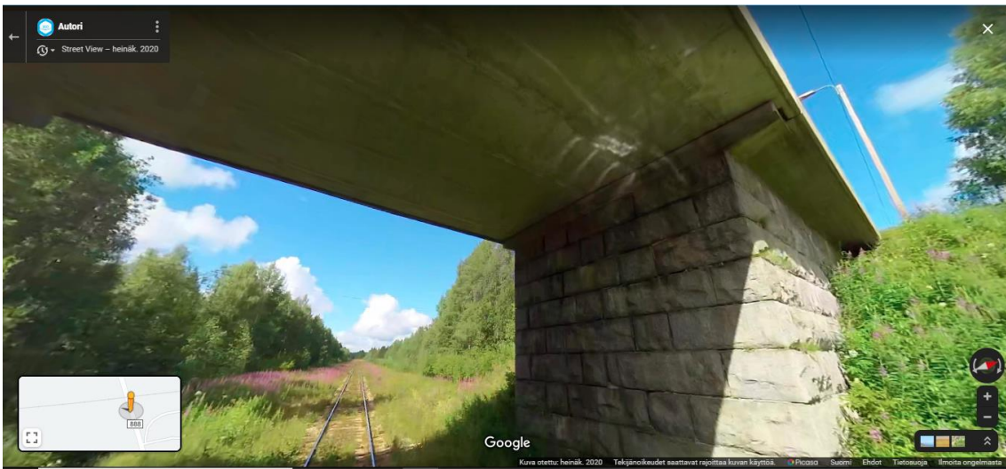
KUVA 10. Kiskopyörin varustetun auton katolle asennetulla 360°-kameralla otettu kuva käännettynä osittain ylöspäin, jolloin radan ylittävän sillan rakenteita voi tarkastella (10)
