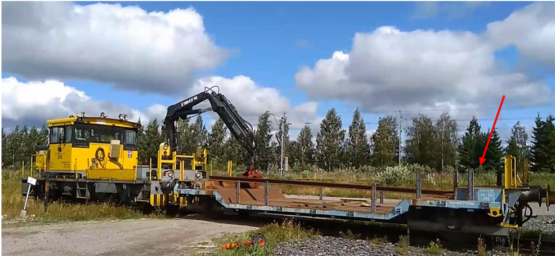
KUVA 11. BUi-v-tyypin virkatarvevaunu kytkettynä Tka7-sarjan ratakuorma-autoon
