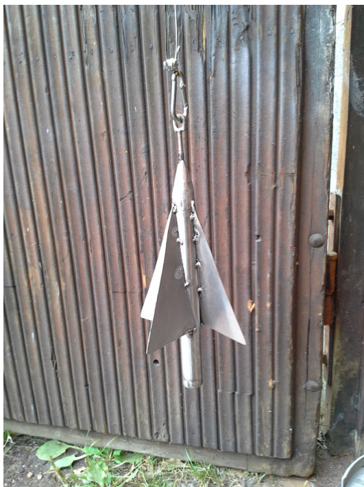
Figur 3. Egenkonstruerad loggpropeller (författarens eget arkiv).
