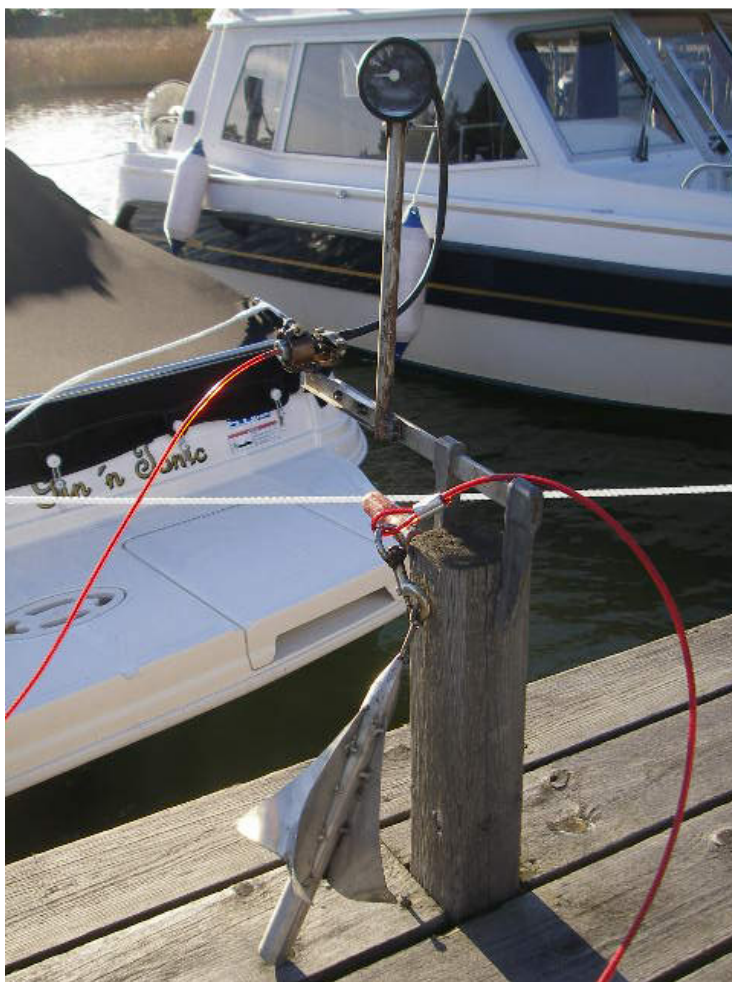
Figur 7. Bild på bockad propeller, mätare och ställning (författarens eget arkiv).
