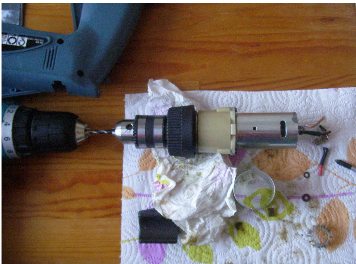
Figur 2. Provdrawing av bormaskins planetväxel (författarens eget arkiv).
