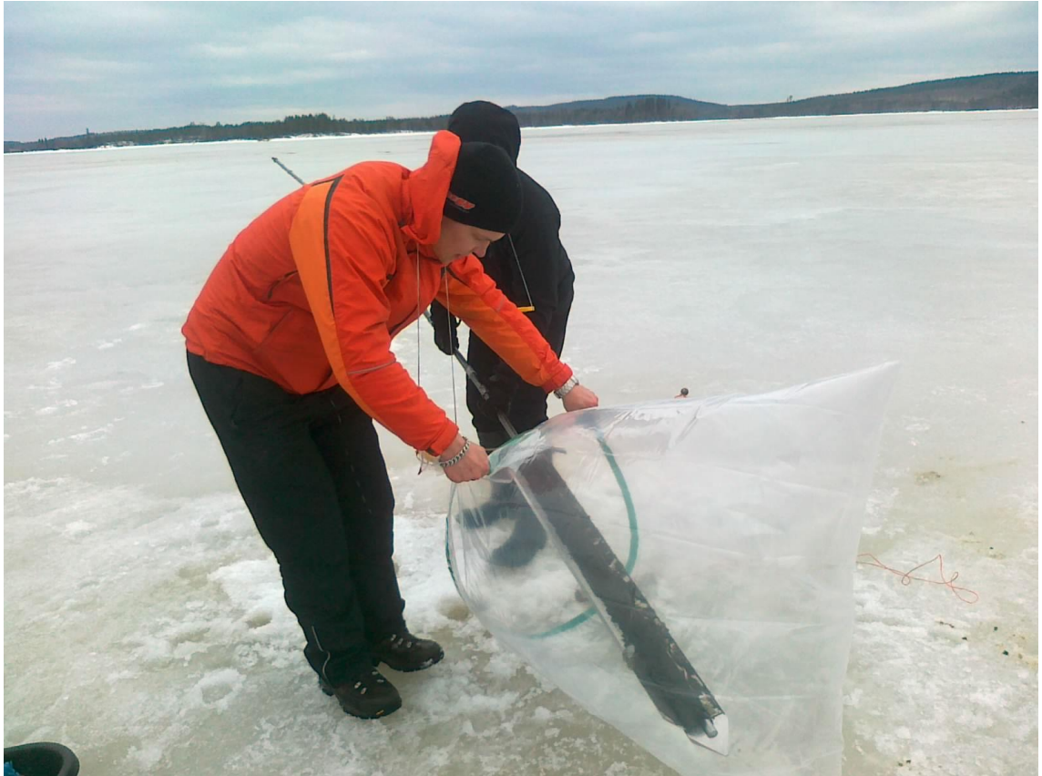
Kuva 13. Polttokokeeseen menevä osuus sedimentistä kerättiin pussiin, koska sedimentin määrä oli suurempi kuin ICP-analyysiin tarvittava määrä (Kuva: Tarmo Tossavainen)
