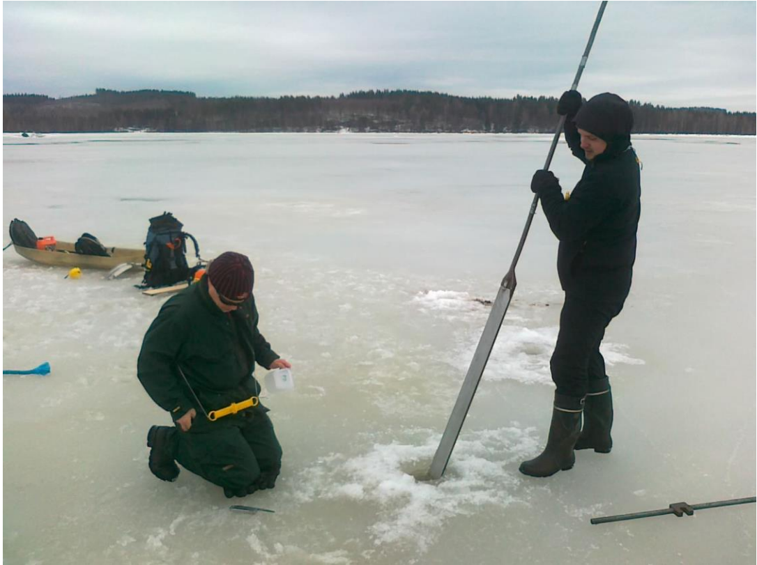
Kuva 11. Sedimentinäytteen nosto sedimenttikairalla (Kuva: Tarmo Tossavainen)
