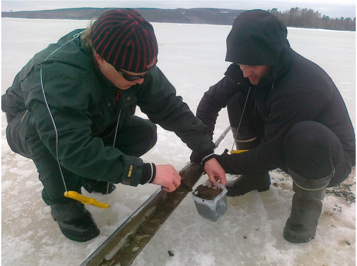
Kuva 12. Näytteet kerättiin pakasterasioihin sedimenttikairasta (Kuva: Tarmo Tossavainen)
