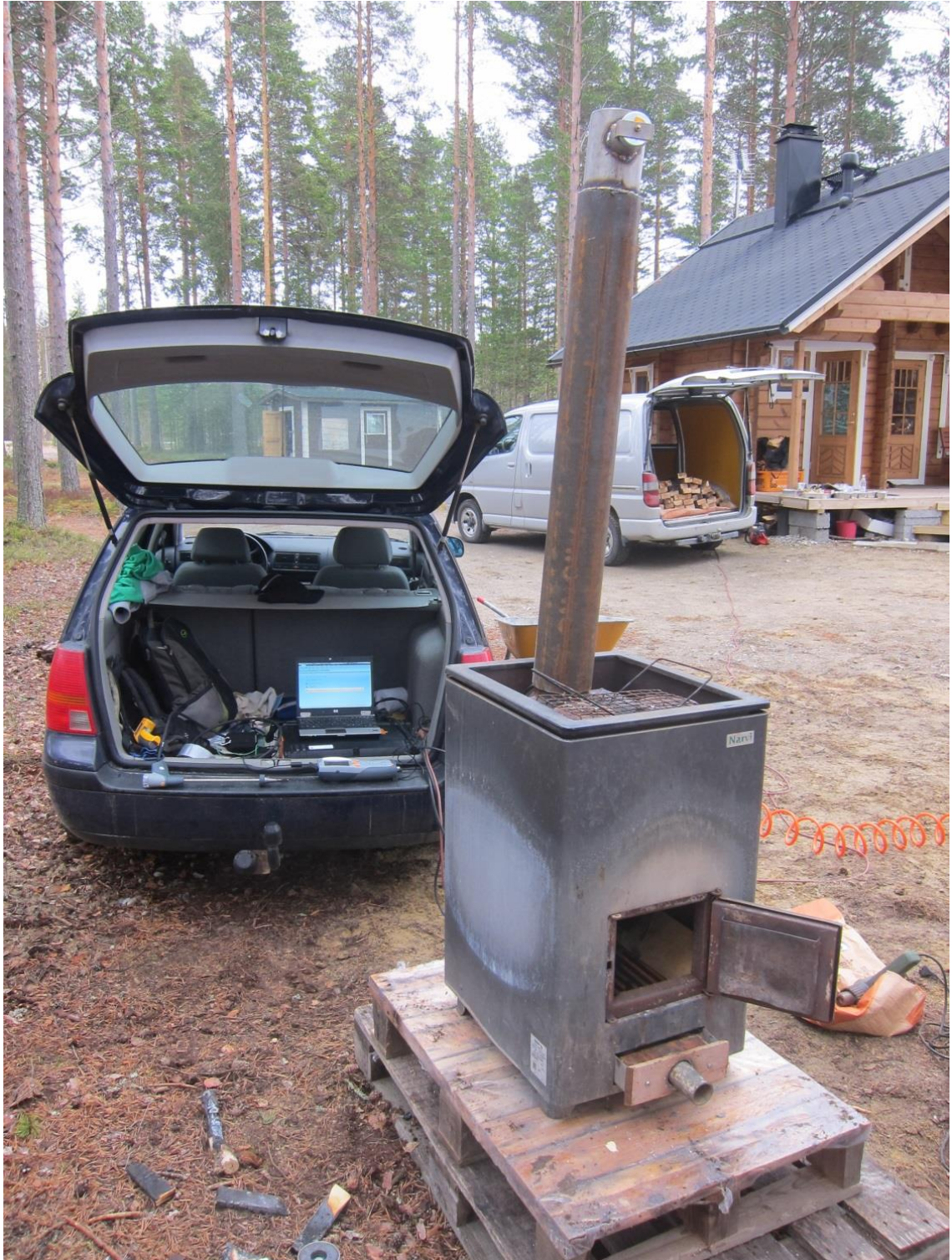
Kuva 15. Polttokokeissa käytetty polttolaite (Kuva: Markus Hirvonen)
