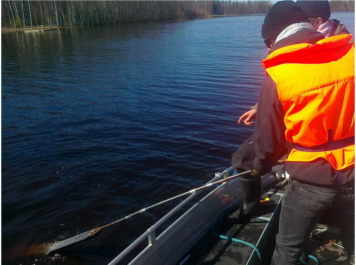
Kuva 14. Myös Jukajärven sedimentin nosto suoritettiin sedimenttikairalla. Nosto suoritettiin veneestä käsin (Kuva: Tarmo Tossavainen)
