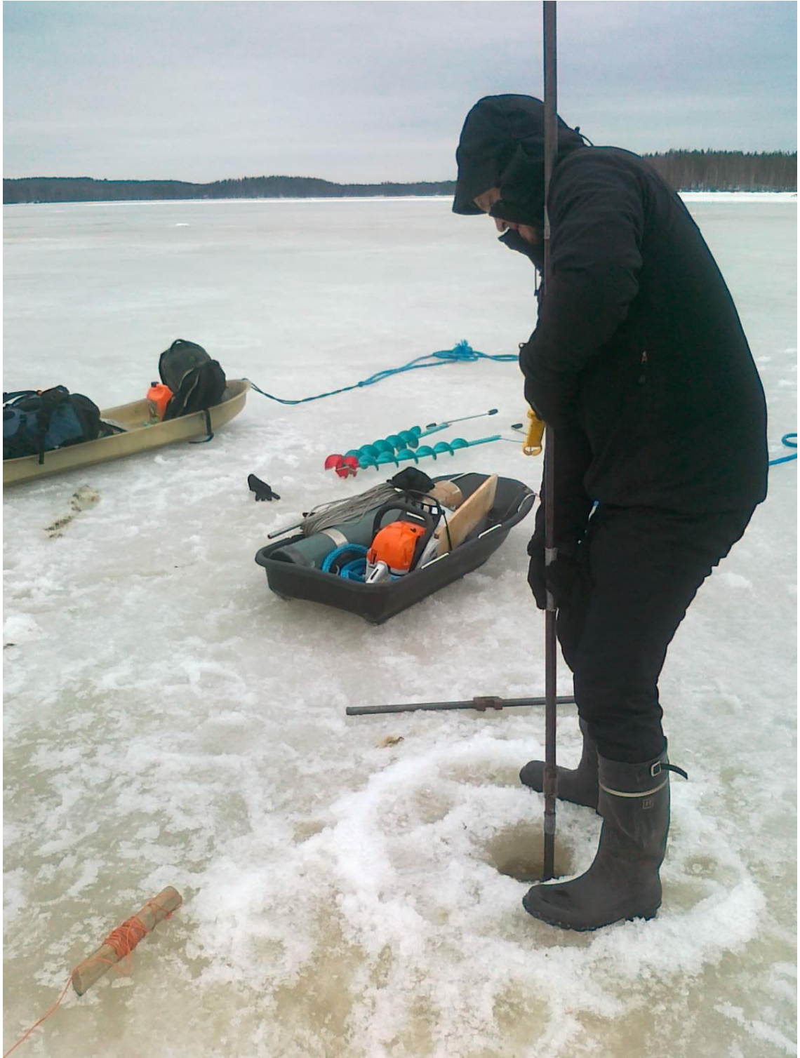
Kuva 10. Loitimon sedimentin nosto ja siinä käytetyt varusteet (Kuva: Tarmo Tossavainen)
