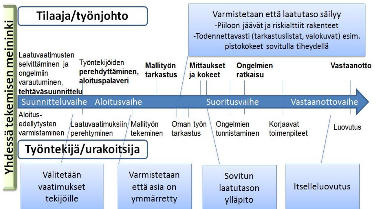
Kuvio 20. Työvaiheen laadunhallinnan toimet aikajanalla osapuolittain (Muokattu lähteestä Siikanen, 2009a, 33)
