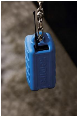
KUVA 10 Kemiran jatkuvatoiminen rikkivetymittari (Anttila 2013).
