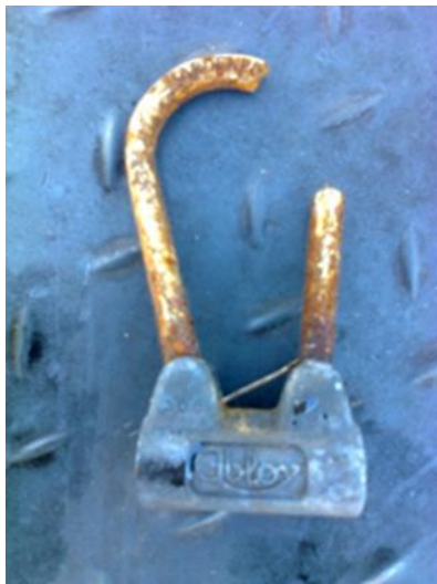
KUVA 5 Rikkivedyn korrodoima riippulukko (Pulkkinen 2013).
