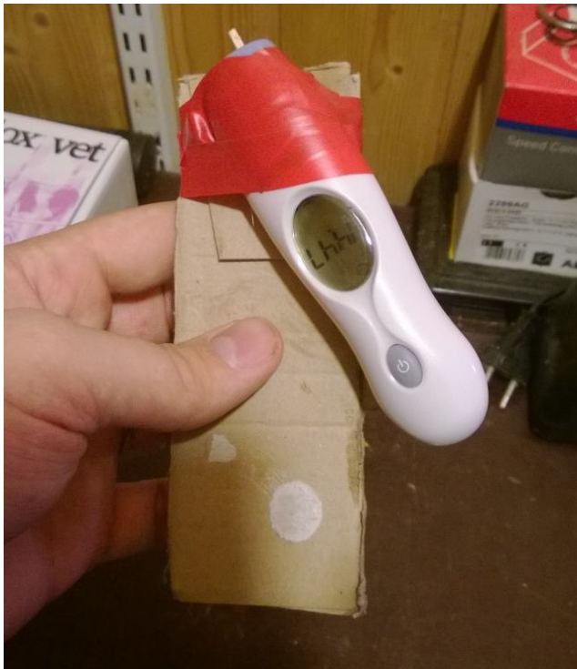
KUVIO 14. Lämpötilan mittauksen helpottamiseen tehty apuväline.
