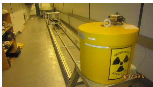
Kuva 6. Toimintakoeradon säteilylähde (Cs-137) /8/
