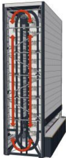
KUVA 1. Varastoautomaatti eli tietokoneohjattu varastointi- ja nimikkeiden siirtojärjestelmä (9)
