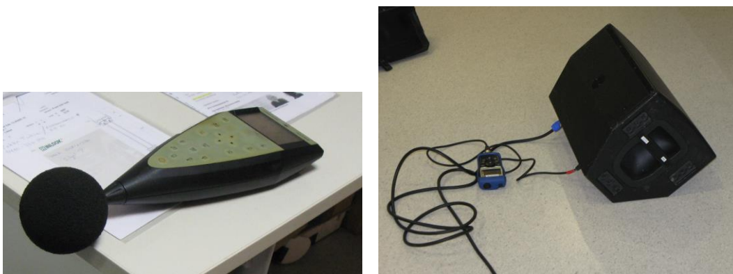
Kuva 25. Mikrofoni ja äänilähteenä käytetty kaiutin.
