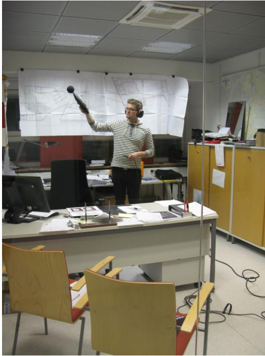
Kuva 27. Jälkikaiunta-ajan mittausta huoneen puolelta.
