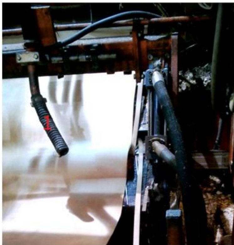
Kuva 6 Puukkojätteen poisto vanhalla puhaltimella. Kuva Ilkka Solismaa 2014.
