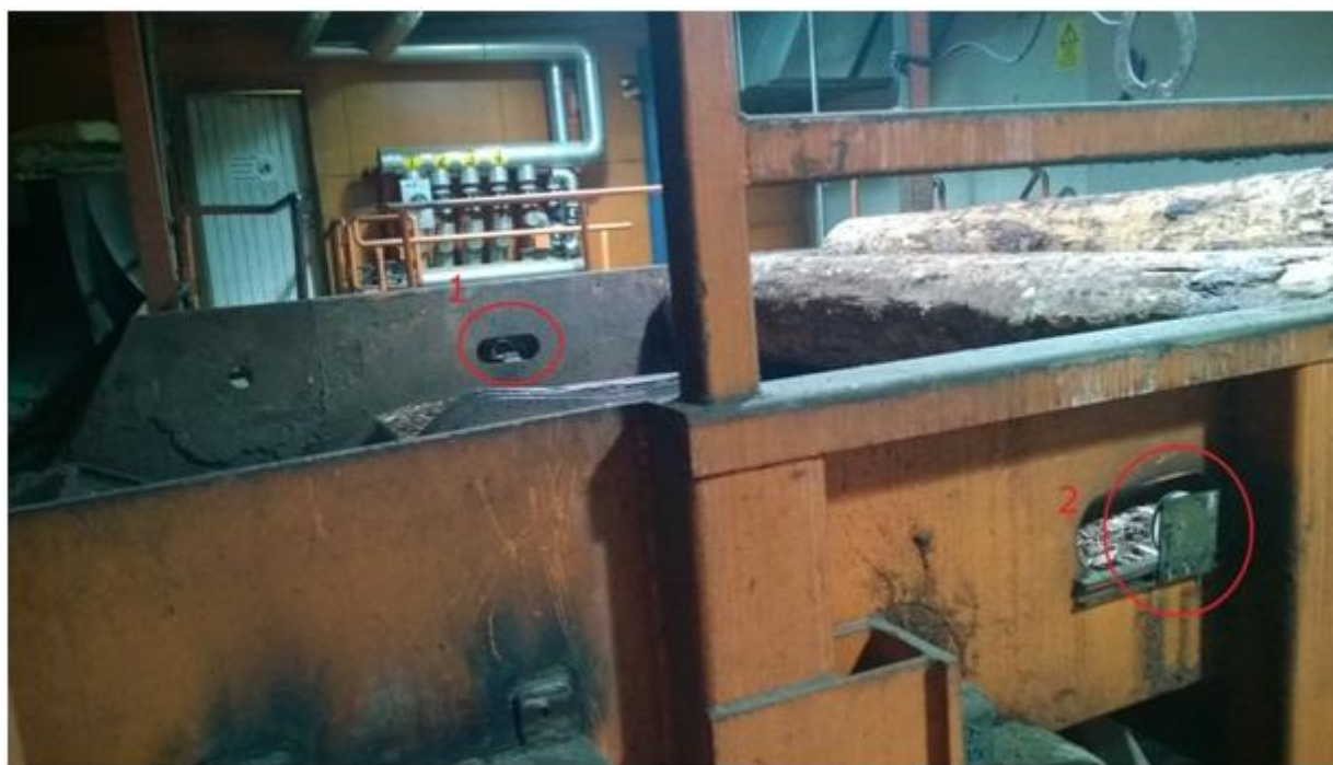
Kuva 4 Välivarastokuljettimen valokenno. Kuva Ilkka Solismaa 2014.
