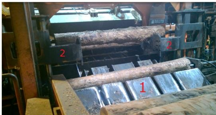
Kuva 8 Keskittäjä ja keskittäjän porrasannostin. Kuva Ilkka Solismaa 2014.
