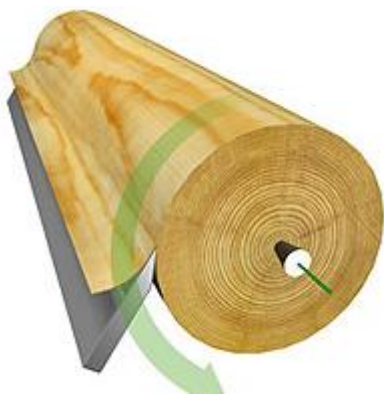
Kuva 2 Viilun valmistus sorvaamalla (Puuproffa www-sivut .)
