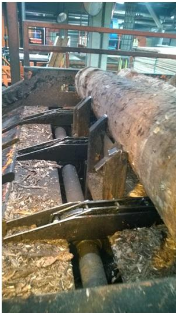
Kuva 9 Välivarastokuljettimen stopparit. Kuva Ilkka Solismaa 2014.
