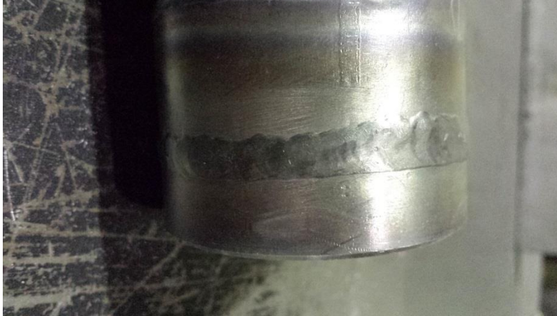
Kuva 7. Hallitsematon sulan muodostuminen ja reunahaava.
