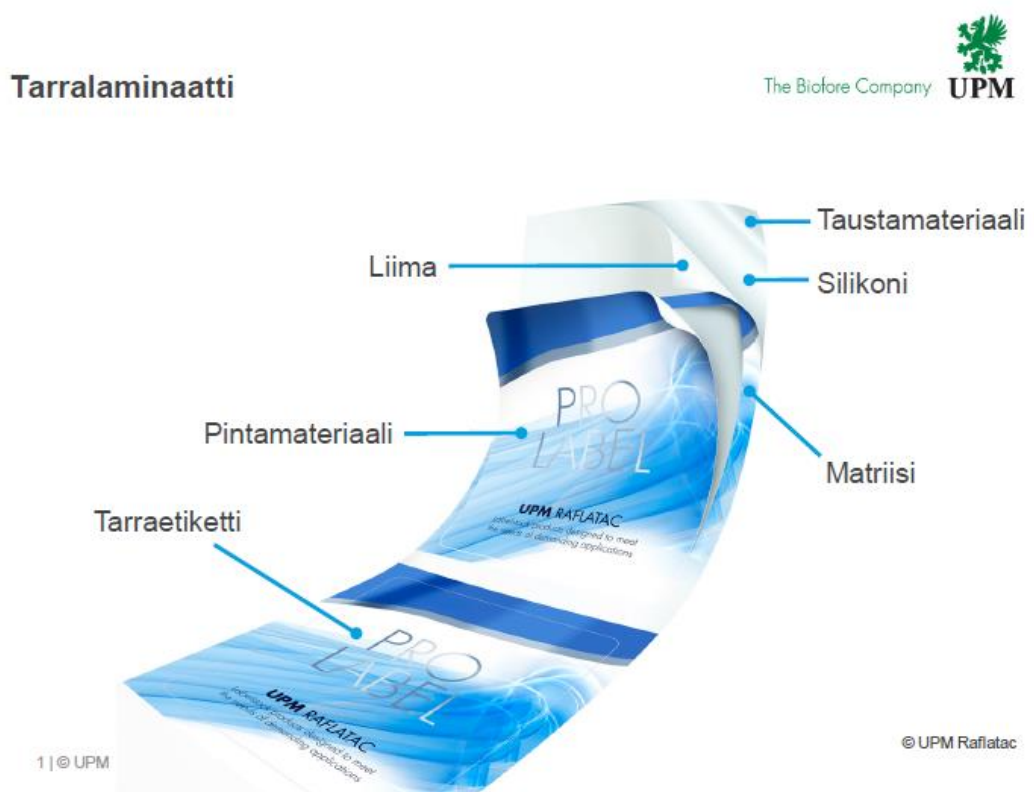
KUVA 1. Tarralaminaatin rakennekuva (UPM Raflatac)
