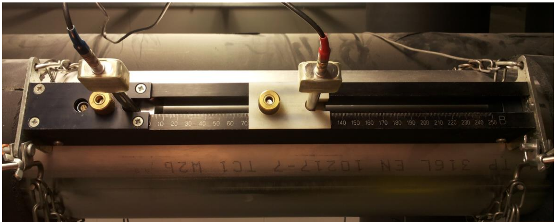
Kuva 6. Krohne UFM 610P -ultraäänivirtausmittarin anturikokoonpano (transducer set) asennettuna putkeen mittaamaan virtausnopeutta putken sisällä.
