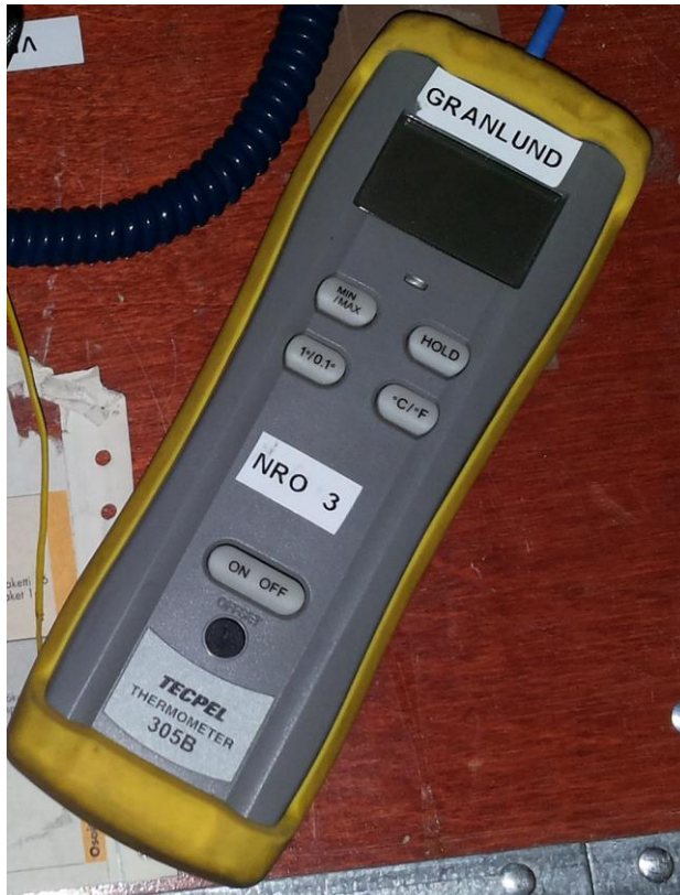
Kuva 8. Lumikertymän lämpötilan mittaamiseen käytetty lämpötilamittari Tecpel DTM 305B.
