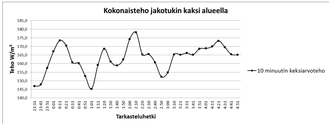
Taulukko 8. Ultraäänivirtaama- ja lämpötilamittarin automaattisesti tallentamista mittaustuloksista laskettu kokonaistehon vaihtelu mittaustulosten kymmenen minuutin keskiarvona 31.01.2014–1.2.2014 kello 23.31–04.51.
