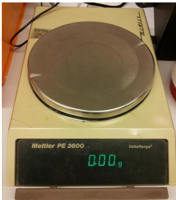
Kuva 9. Lumi- ja jäännöskertymän massan punnitsemiseen käytettiin Mettler PE 3600 -vaakaa.
