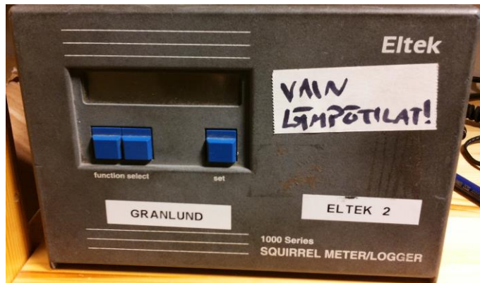
Kuva 7. Eltekin 1000 series Squirrel meter/logger -mittari, jolla kerättiin sulanapitojärjestelmän jakoputkessa virtaavan lämmönsiirtonesteen meno- ja paluujohtoon lämpötila.
