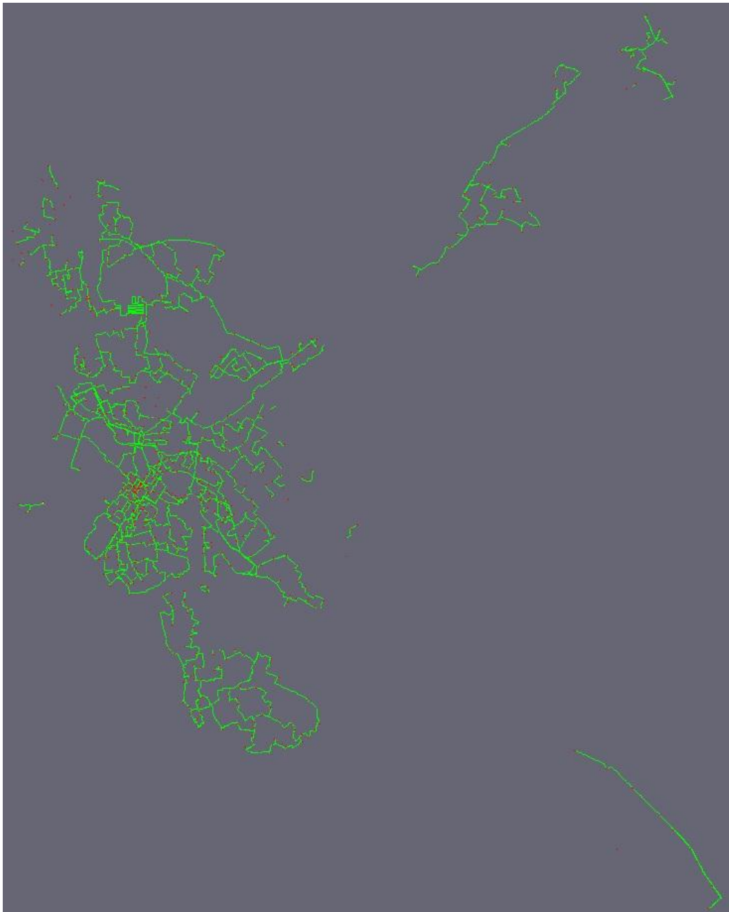
Kuvio 17. Laajan maadoituksen maadoitustaso Tekla NIS - verkkotietojärjestelmässä
