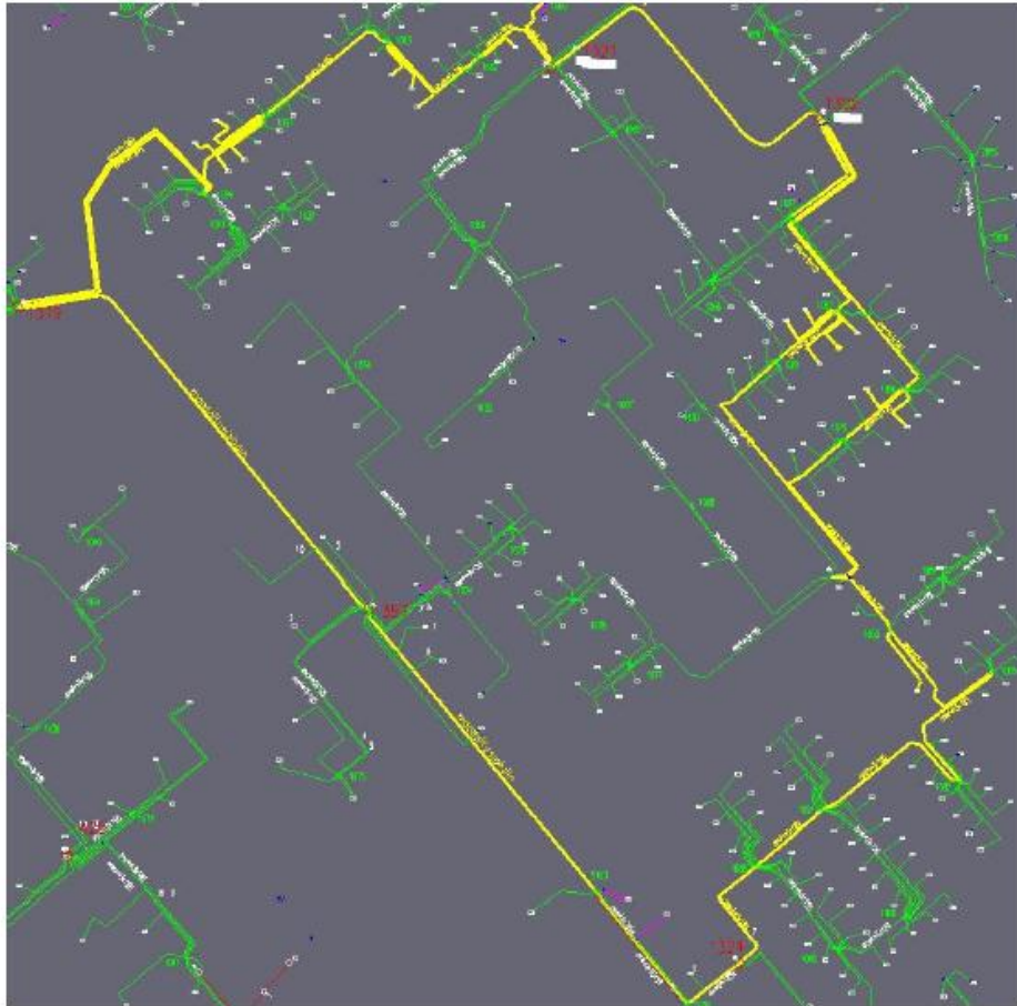
Kuvio 3. Muuntajien 1321 ja 1322 yhdistävät johtimet laajaan maadoitukseen.
