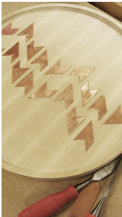
● bild 37: tillverkning av intarsiamönstret i koppar
