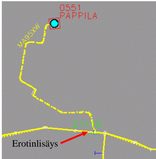
KUVA 43. Orivon lähdölle lisättävä erotin
