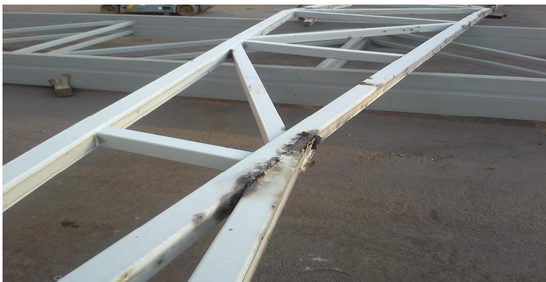
Kuva 32. Puutteellinen pintakäsittely hitsauksen jälkeen (kuva: Jari Saarinen)
