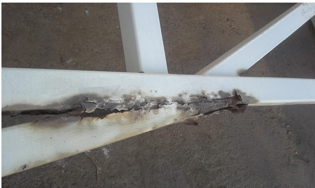
Kuva 33. Puutteellinen pintakäsittely hitsauksen jälkeen (kuva: Jari Saarinen)
