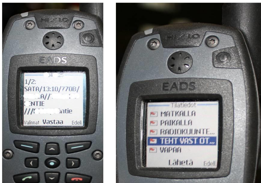
Kuva 1. Hätäkeskuksen antaessa tehtävän päätelaite antaa äänimerkin ja ilmoitus talentuu siihen tekstiviestinä. Tehtävän aikana yksikön tilatiedot tehtävänvaiheistaan lähetetään näppäimistöllä hätäkeskuksen tietojärjestelmään. (Aalto 2013)
