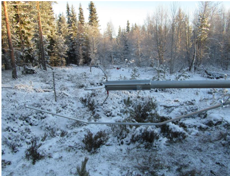
Kuva 24. Ukkosenjohdatin ja ultraäänianemometri maston huipulla.
