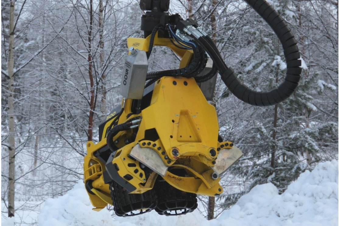
KUVA 1. Moipu 500 giljotiini hakkulaite (Moisioforest, 2013).
