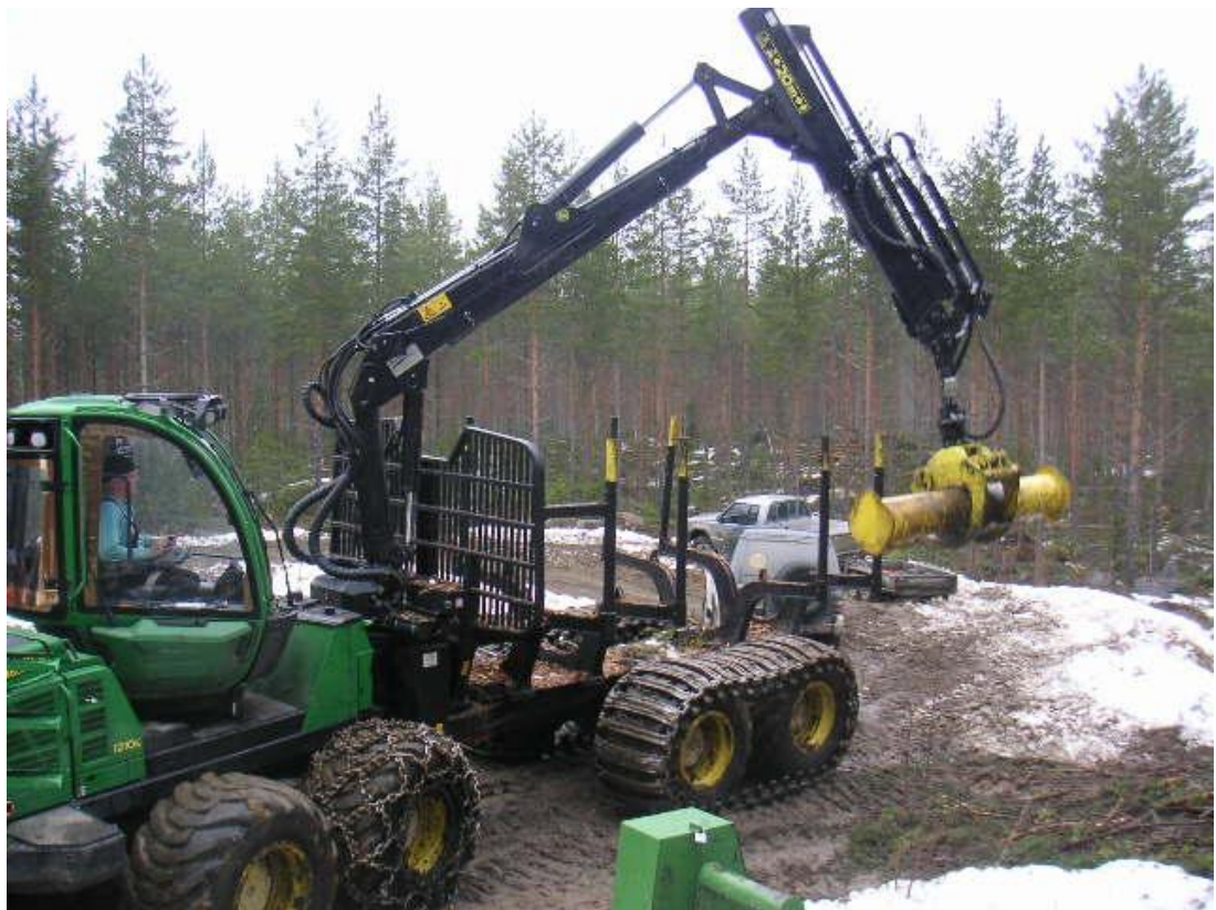
KUVA 3. Kuormainvaakamittaukseen liittyvä kalibrointi käynnissä (Leinonen 2012).
