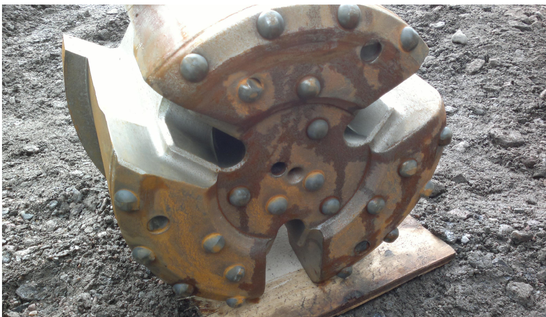
Kuva 7. Kuvassa näkyy metallijätteen takia hajonnut porapaalukoneen poranterän kruunu [9].
