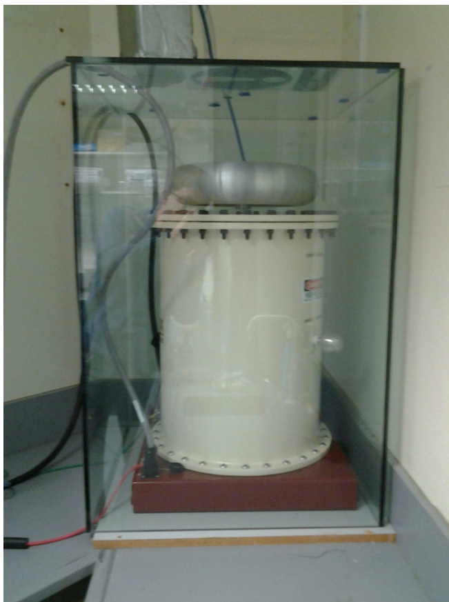
KUVA 2. Suurjännitemuuntaja (0-120 kV, 125 mA)
