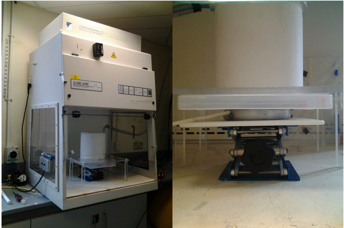
KUVA 3. Elektrodit sisältävä vetokaappi (vasemmalla) ja elektrodien asemointi (oikealla)
