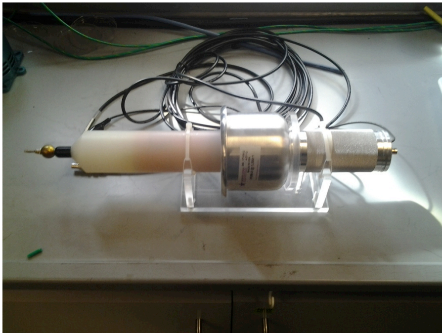
KUVA 5. North Star PVM-6 60 kV suurjännitekoetin
