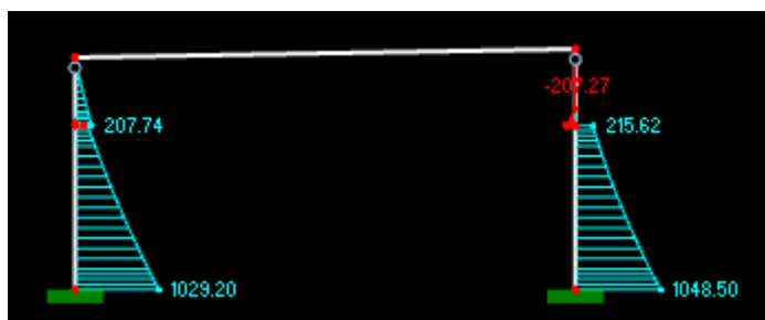
KUVA 12. RFEM -mallin kehän momentit (Laitinen 2014-02-05)
