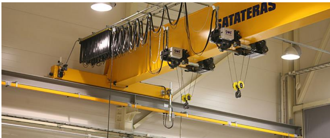
KUVA 6. Esimerkkikuva siltanosturista ja rataksista (www.satateras.fi)
